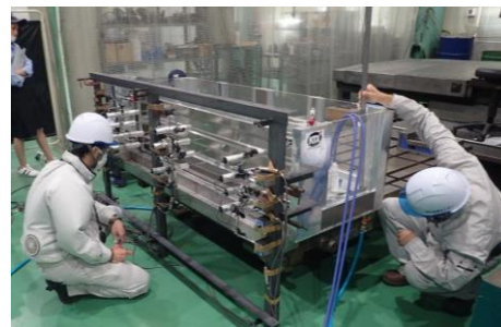
第三者機関による浸水防止試験の様子
